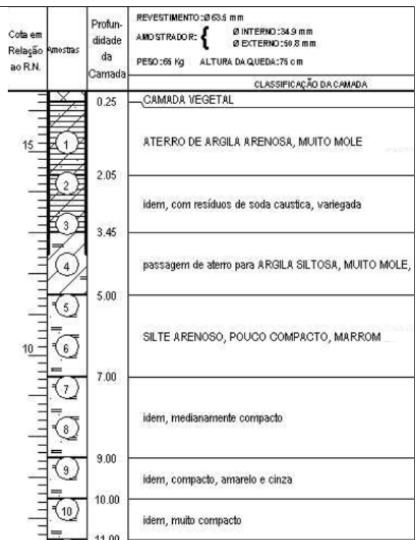
Figura 05– Perfil da sondagem SP-120, localizada próxima ao dique de contenção de jusante da ADR
