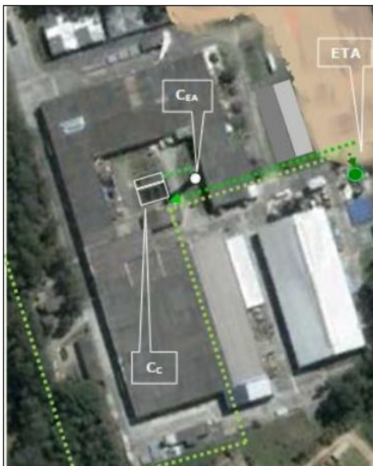
Figura 12 - Foto das redes(circuitos) de tubulações que interligam a cisterna central a ETA e a caixa elevada de água
